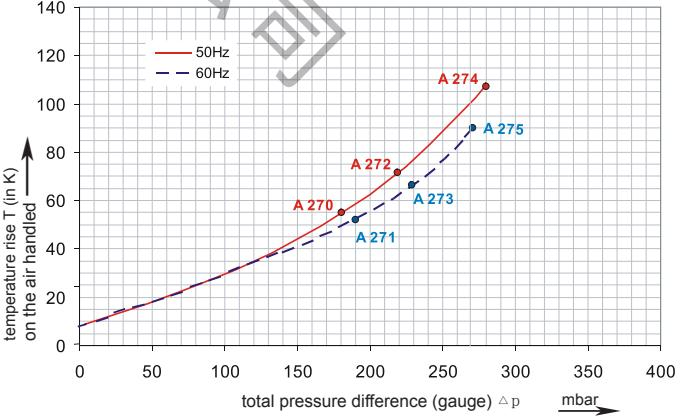
性能曲线基于温度为15°C、大气压为1013毫巴的空气，公差为 $\pm 10\%$ 。总压差适用于最高25°C的吸入温度和环境温度。
